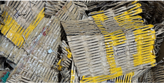
科力普将纸箱加工成网状缓冲填充物
